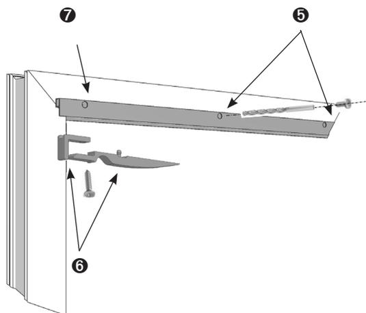
5 Oberkante Laufschiene nach den Markierungen ausrichten. Durch die Montagebohrungen ggf. vorbohren und mit RK 4,0x16 anschrauben. Abdeckkappen aufstecken.
